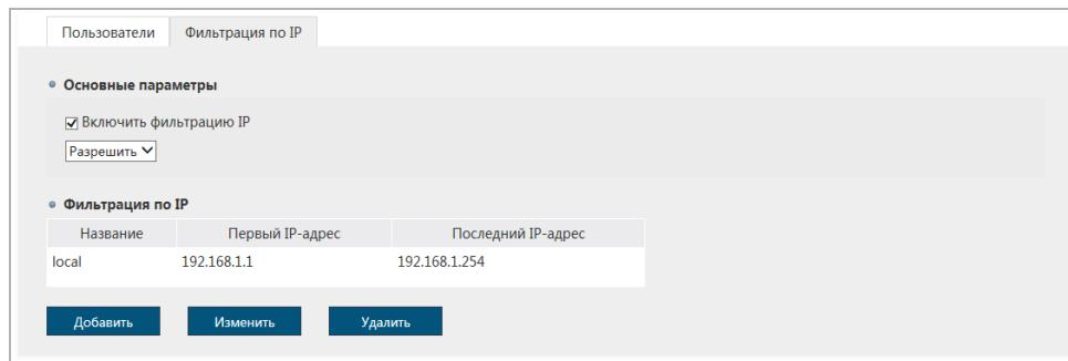
Используя настройки фильтра по IP можно ограничить доступ к IP-камере с одного или нескольких сетевых устройств.
