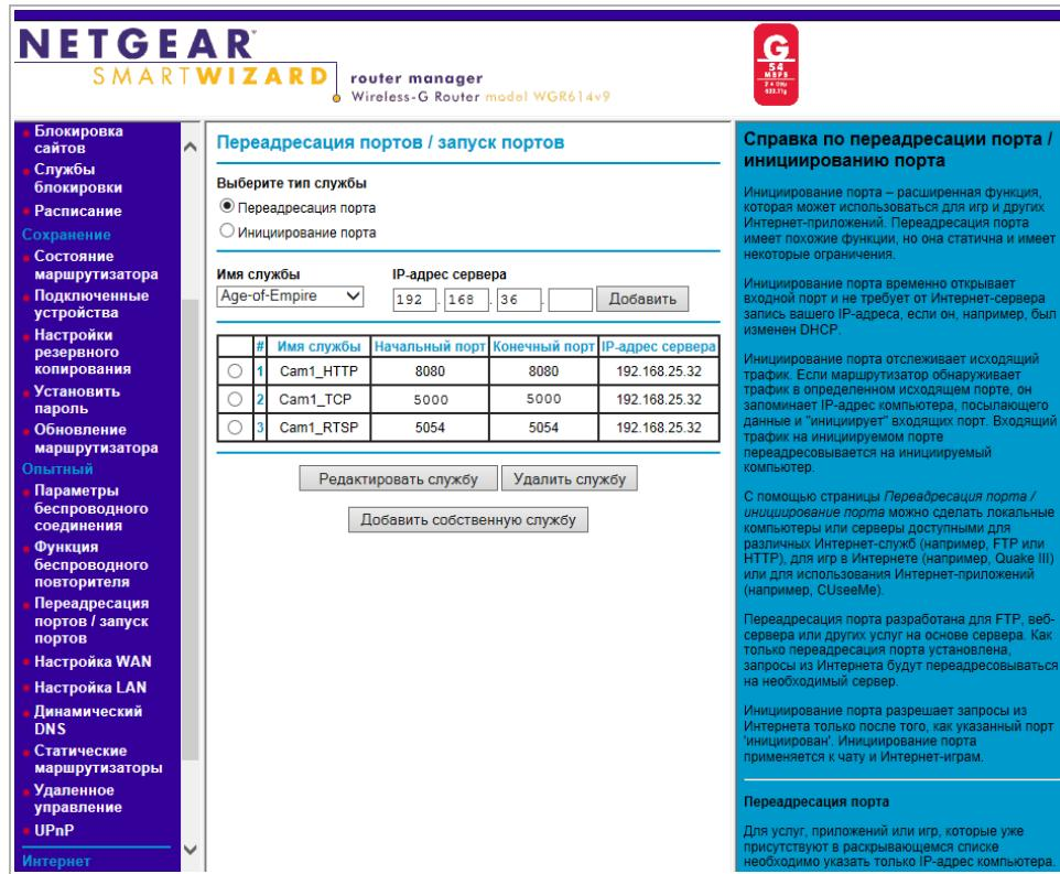
Для получения доступа к IP-камере из сети Интернет введите в браузере <внешний ip-адрес роутера>:<порт подключения к web-интерфейсу камеры>.
