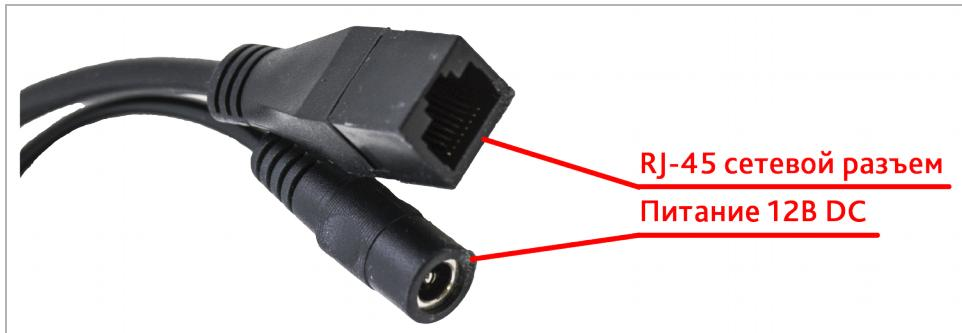
Внешние разъемы IP-камер AC-D2111IR3:
