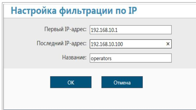
В открывшемся окне **Настройка фильтрации по IP [IP Filtering Settings]** введите **Первый IP-адрес [Start IP]** диапазона и **Последний IP-адрес [End IP]**. В поле **Название [Alias]** введите название данного диапазона IP-адресов.
