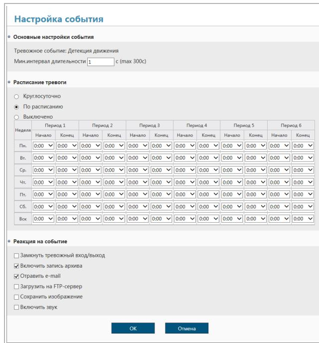
В блоке **Основные настройки события [General]** указывается тип настраиваемого события. В поле **Мин. интервал длительности [Min. interval of trigger event]** установите время, по которому будет определяться наступление события. То есть, если тревожное событие длится меньше указанного времени, то оно считается не наступившим.
